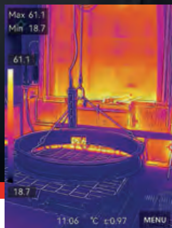
Wärmebild eines Motorbauteils während der Beladung des Trockenofens
