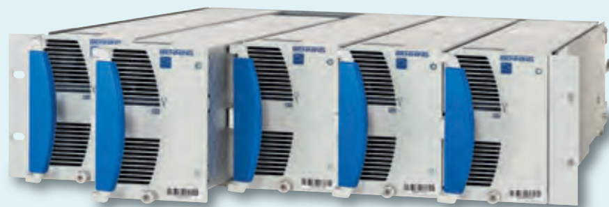
19" Einschub mit TEBECHOP 3000 SE Leistungsmodulen – Jedes Gleichrichtermodule liefert eine maximale Ausgangsleistung von 1800 W bzw. 3000 W. In einen 19" Gleichrichtereinschub können bis zu 5 Leistungsmodulen eingebaut werden, sodass der Leistungsbereich von 1800 W bis 15000 W abgedeckt wird
