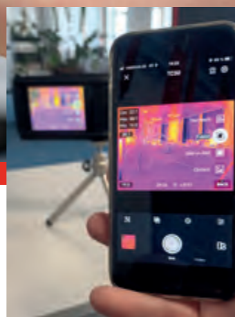
Übertragung des Thermografiebildes von der Kamera per Hotspot auf ein Smartphone
