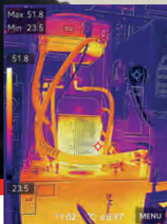
Thermografische Sichtprüfung von Motor und Druckschläuchen einer Blechstanze ohne Betriebsunterbrechung
