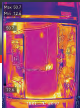
Die Thermografieaufnahme einer Wärmepumpenzentrale zeigt eine Isolationsbeschädigung im Zugangsbereich des Temperaturfühlers zum Wasserspeicher
