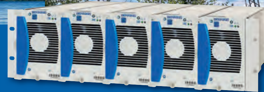
19" Einschub mit INVERTRONIC compact Leistungsmodulen – 19" Baugruppenträger: 5 Wechselrichtermodule, Ausgangsspannung 230 V AC, Ausgangsleistung 7,5 kVA bei 110 V und 220 V, 12,5 kVA bei 48/60 V, 5,5 kVA bei 24 V
